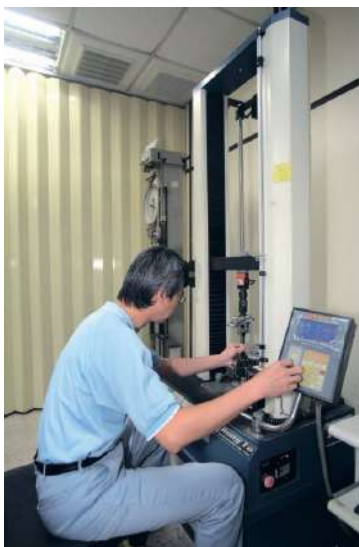
電線電纜材質拉力及伸長試驗
