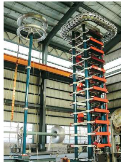
345kV 特高壓電纜衝擊波耐壓試驗
