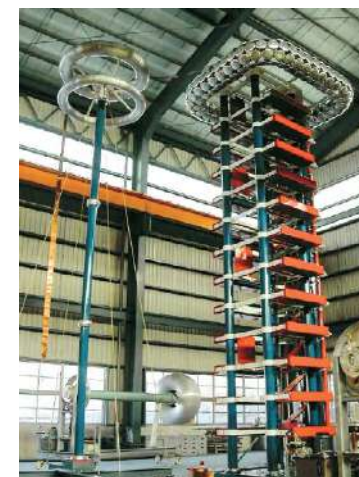
345kV 特高壓電纜部分放電試驗
