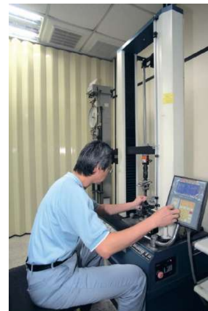
電線電纜材質拉力及伸長試驗
