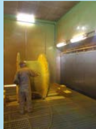
噴漆集塵內部設置改善
